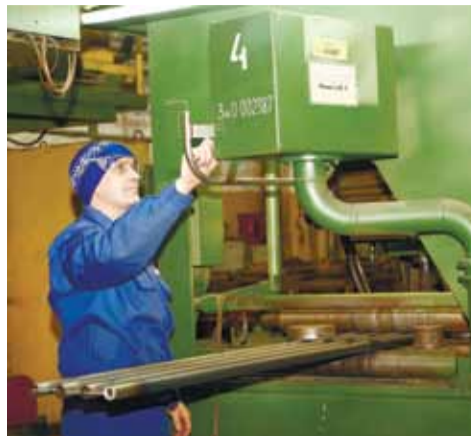
Под слоем флюса свариваются четверки
