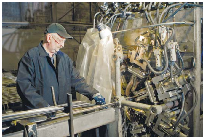
Новая установка для 8-рёберного оребрения труб
