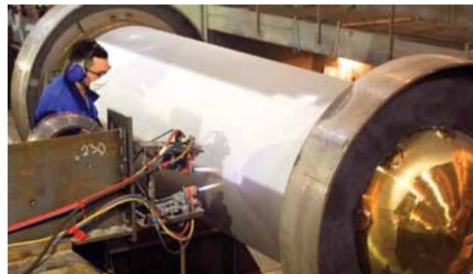
тивном случае могут образоваться слои окислов, которые не позволят получить достаточного сцепления алюминия со стальной подложкой.
