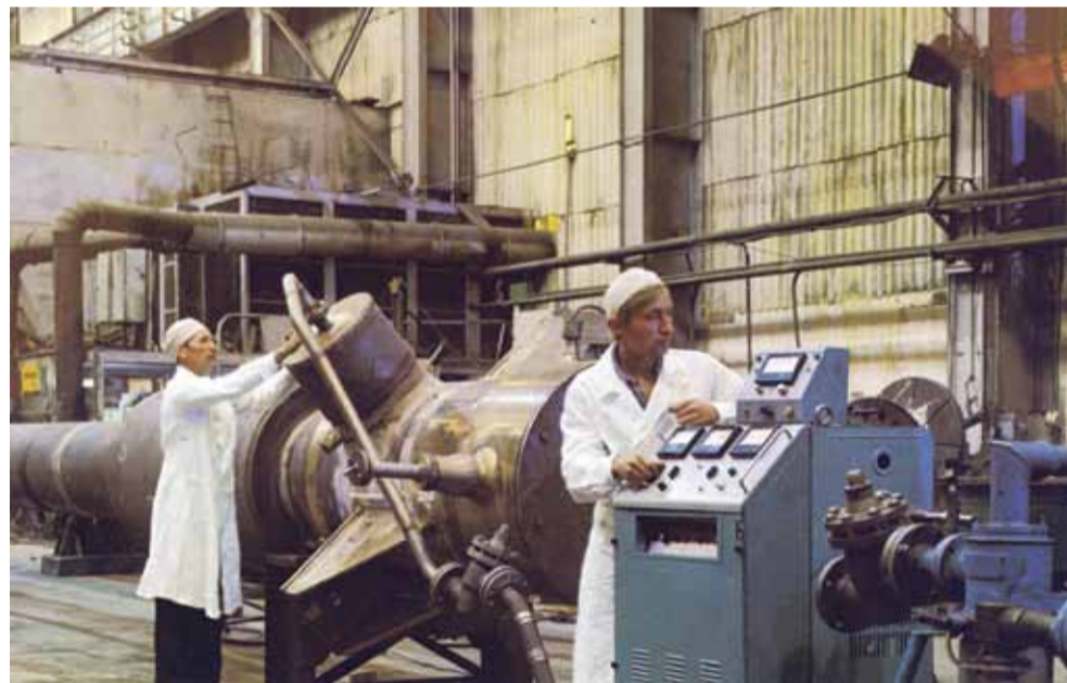
Контроль герметичности модуля парогенератора БН-600, конец 70-х гг.
