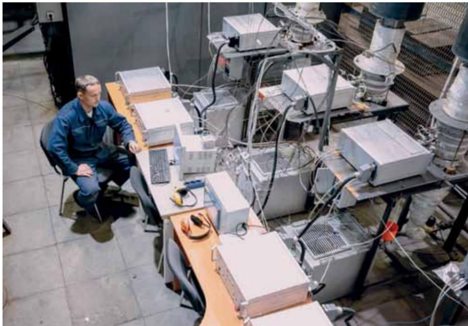
В конце прошлого года завершились термоциклические испытания двух моделей камеры подвода питательной воды и двух моделей камеры отвода перегретого пара для парогенератора РУ «БРЕСТ-ОД-300». Целью испытаний являлось подтверждение надёжности узла заделки труб в трубные доски, его сварного соединения и основного металла теплообменных труб. Актуальность работы определялась отсутствием аналогов на материале теплообменных труб и на сварное соединение «труба – трубная доска».
