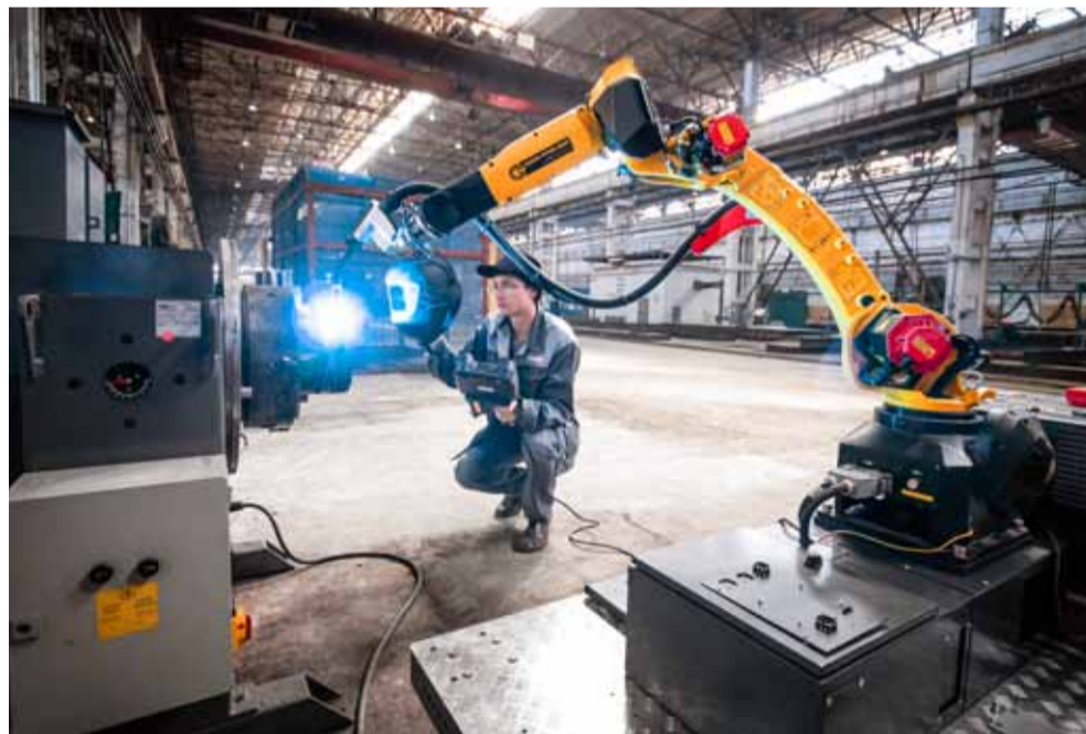
Максим Покорский отработывает режимы наплавки сварочной проволокой Inconel Filler Metal 625
