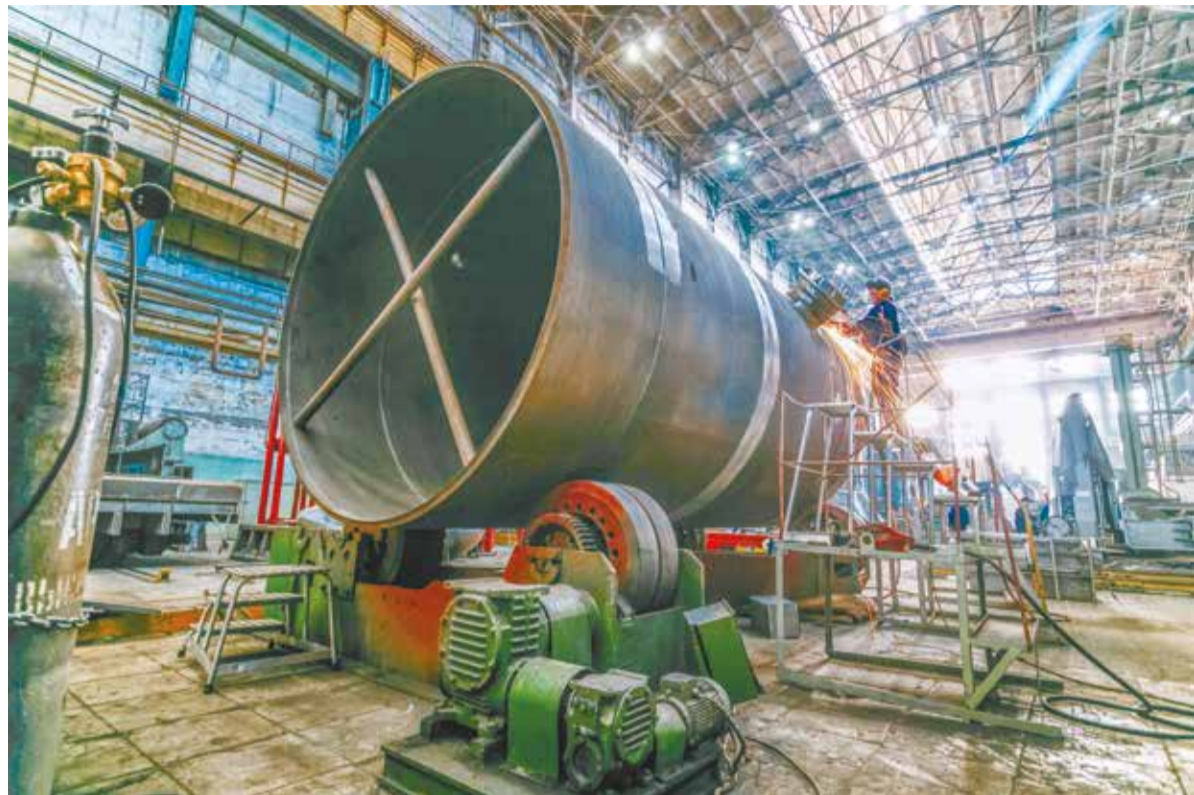
Изготовление корпуса ПВД. Всего же для блока № 1 АЭС «Руппур» завод изготовил более 1500 тонн оборудования
