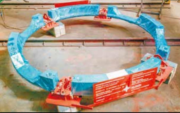
Завод изготовил два опорных кольца для четвёртого ледокола нового поколения проекта 22220 «Якутия», причём со значительным опережением установленного в договоре срока. Кольца установят на баки металловодной защиты реакторной установки «РИТМ-200». К ним будут крепиться парогенерирующие блоки (реакторы) атомохода. Диаметр изделия составляет 3,25 метра, масса – 2,5 тонны.
