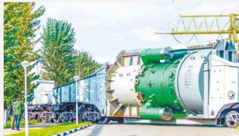
Завод завершил изготовление реакторных установок «РИТМ-200» для трёх атомных ледоколов: «Арктика», «Сибирь», «Урал».
