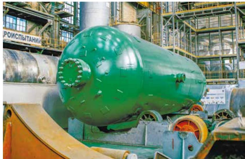
↑ Масса одной ёмкости SAO3 составляет 78 тонн, высота – 11 м, диаметр – 3 м. Срок эксплуатации – 60 лет.
