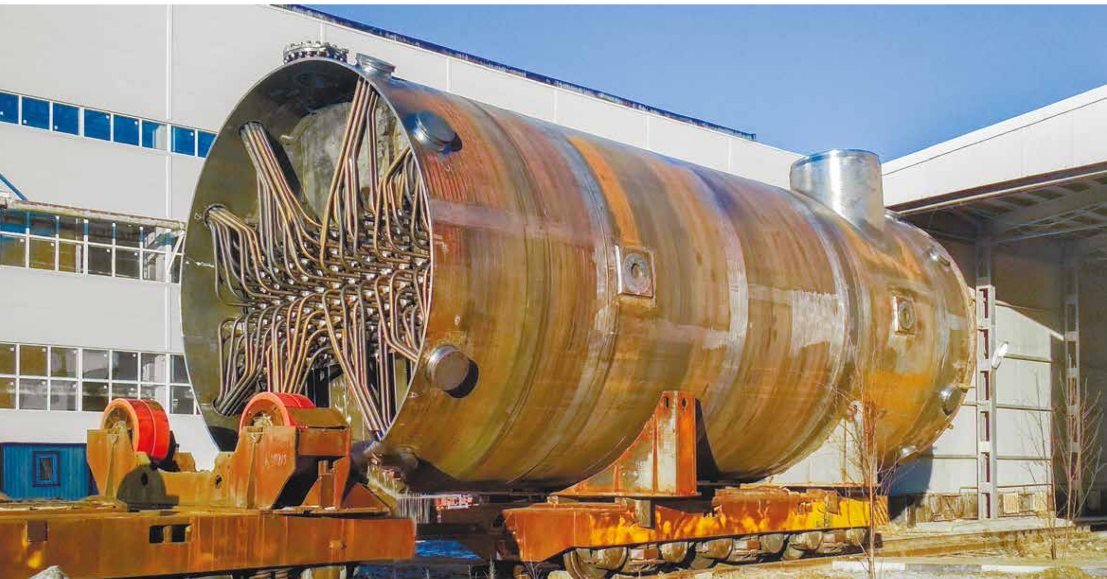
↑ После гидроиспытаний в ПП № 807 пароперегреватель СПП-1200ТОИ перевозят в ПП № 803 на сборку с доннышком
