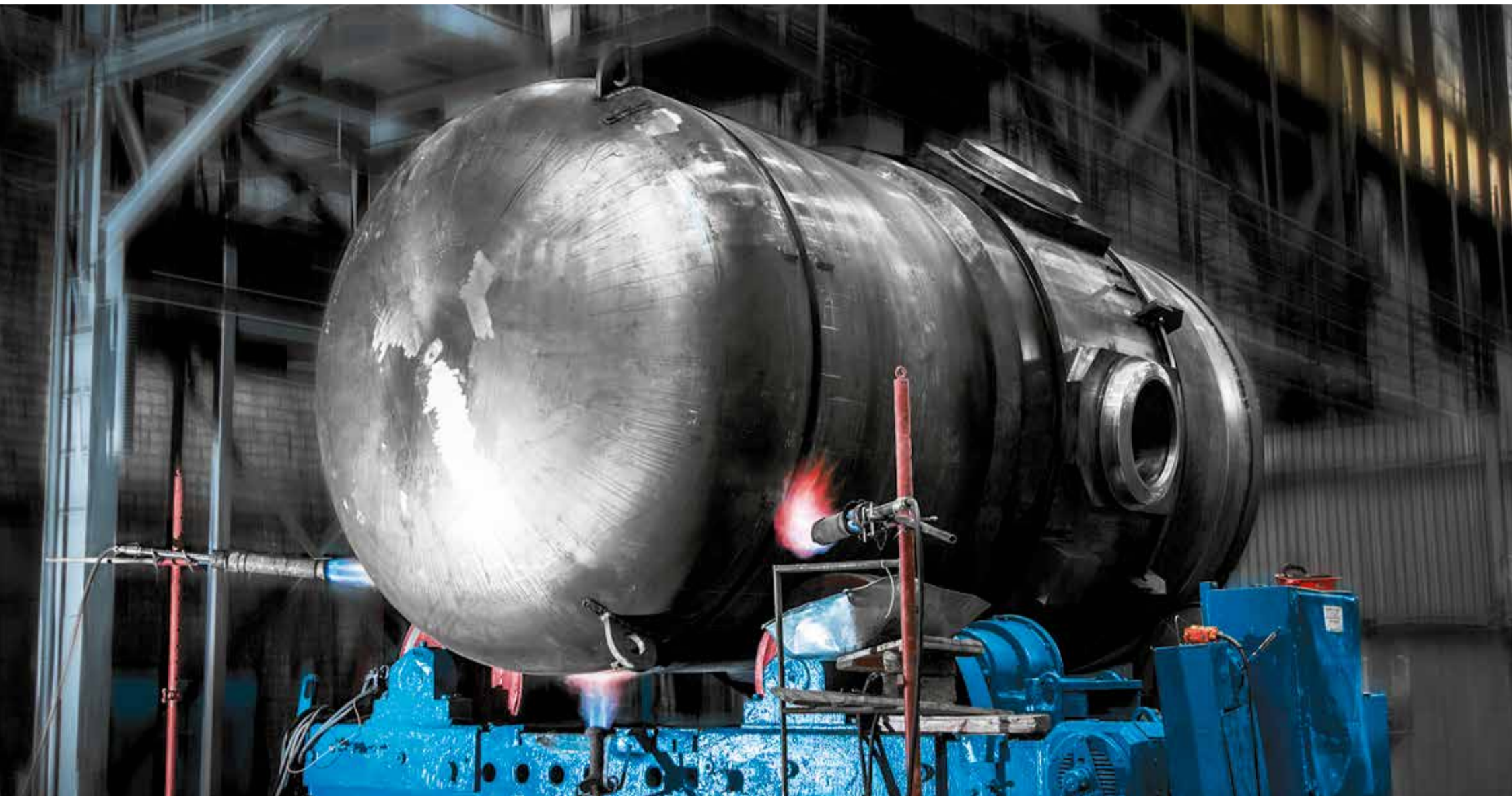
↑ Сборка второго полукорпуса реактора РУ «РИТМ-200»
