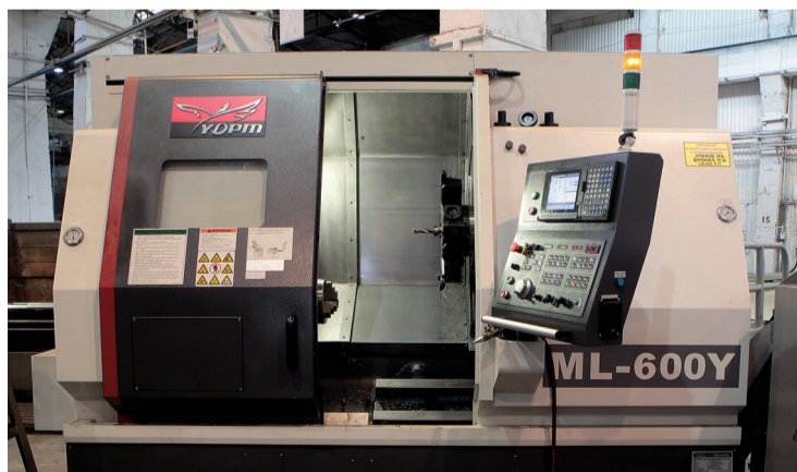
Токарный обрабатывающий центр с фрезерной функцией ML-600Y предназначен для высокопроизводительной обработки деталей
